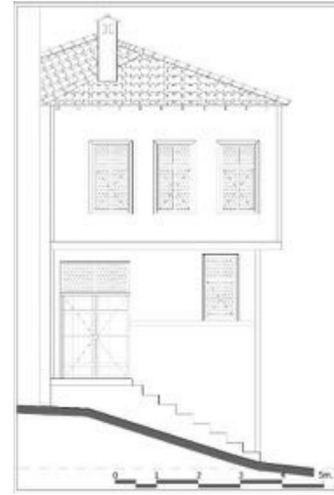
Şekil 26. Restorasyon- Doğu Cephesi
