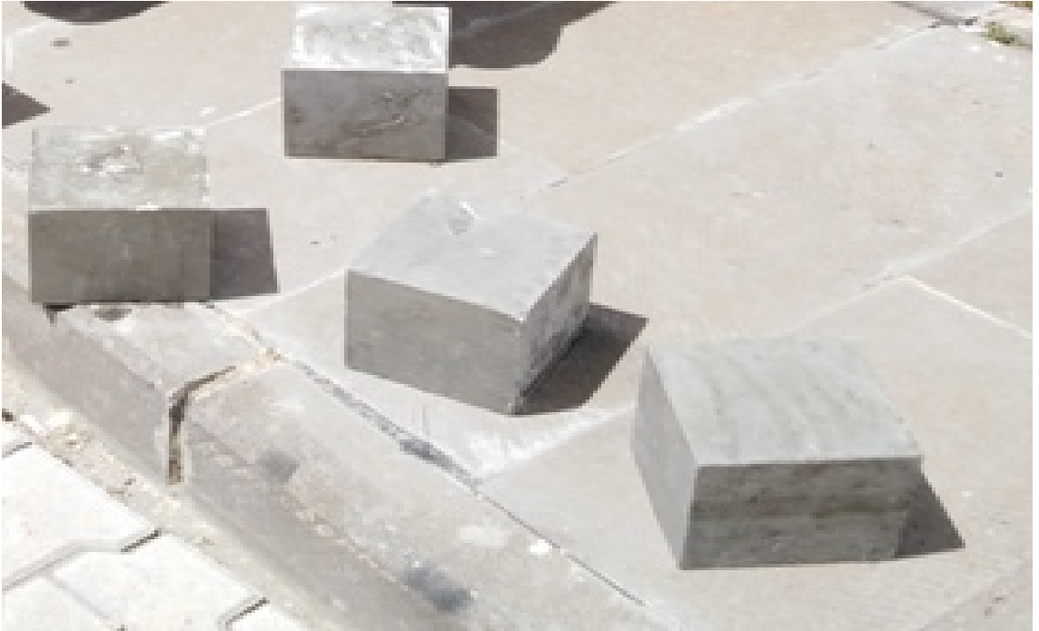
Şekil 3.14. Kür Havuzundan Çıkarılan Sertleşmiş Beton Numuneleri
