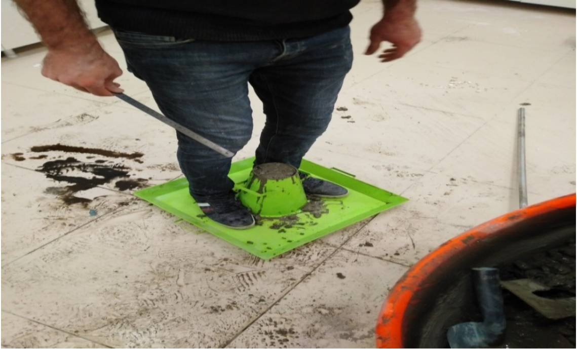
Şekil 3.10. Beton Slump ( Çökme ) Deneyi
