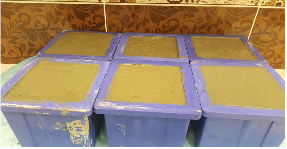
Şekil 3.12. Beton Harcının Kalıplara Konulması
