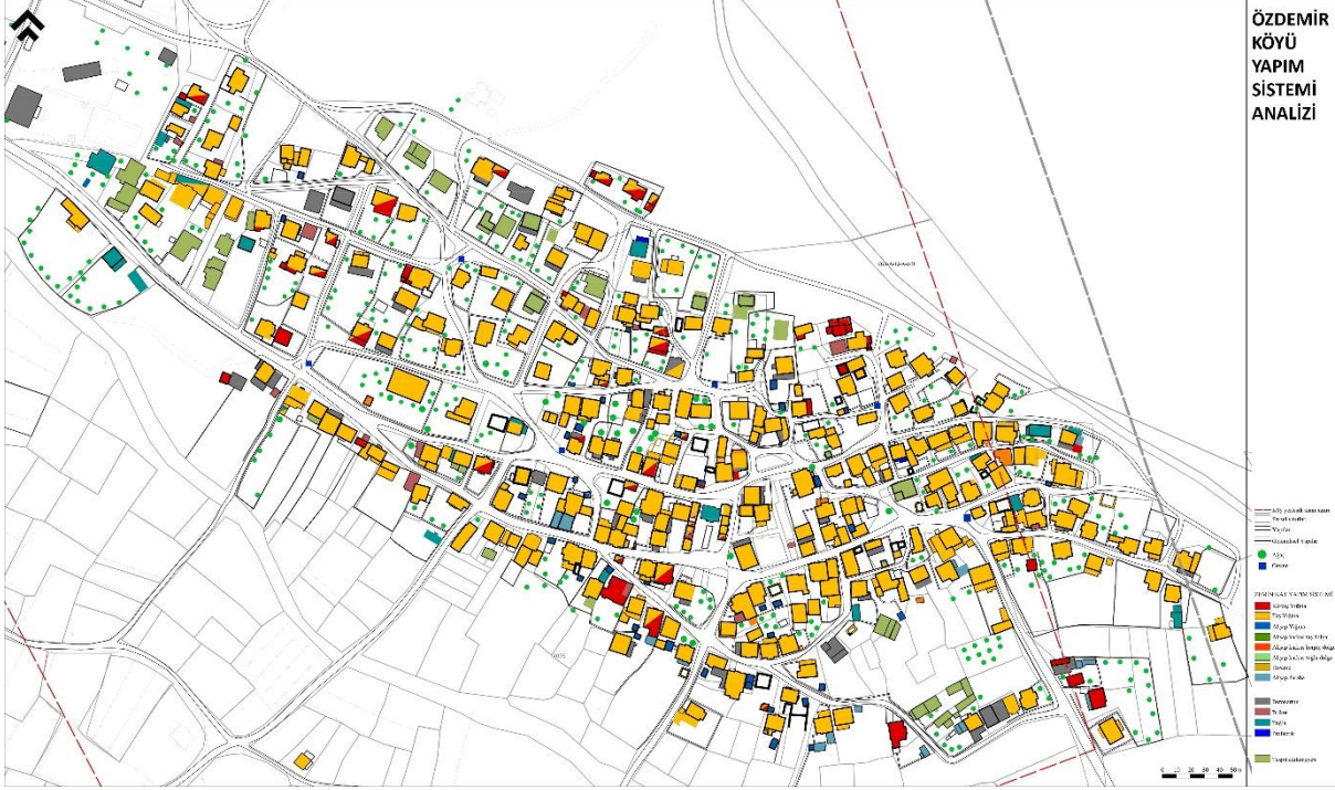
Şekil 13. Özdemir Köyü zemin kat yapım sistemi analizi
