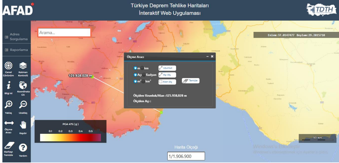
Şekil 4.10. En Yakın Fay Hattının Yapıya Olan Uzaklığı
