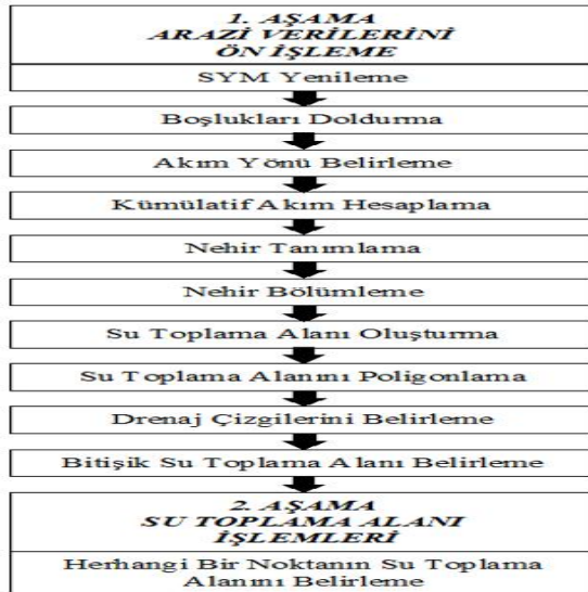
Şekil 3.3-1: ArcHydro ile Su Toplama Havzalarının Belirlenmesi
