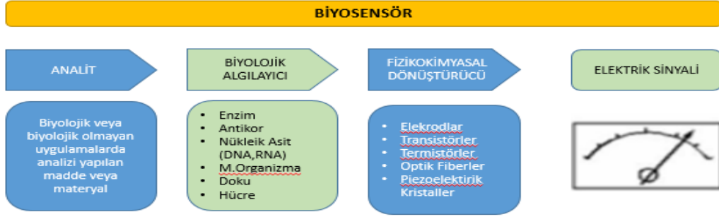
Şekil 1. Bir biyosensörün şematik gösterimi
